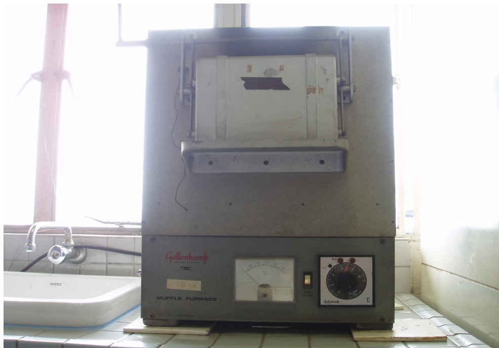
รูปที่ 2 การหาปริมาณ Total ash โดยใช้ Muffle furnace
