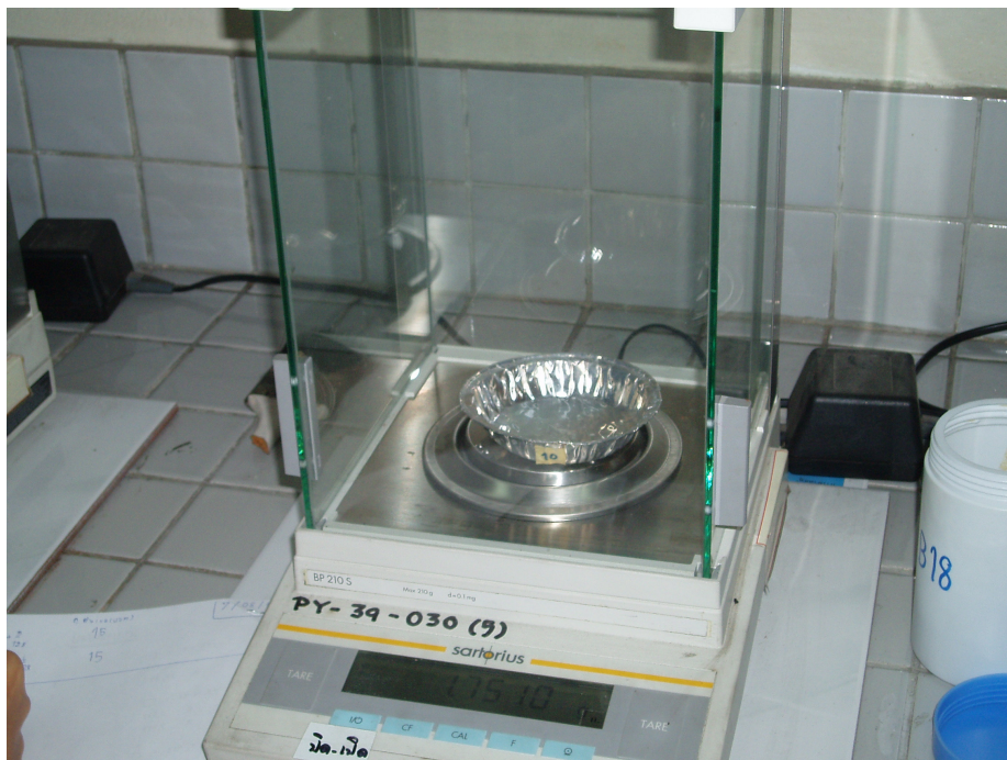
รูปที่ 1 การหาปริมาณความชื้นหรือปริมาณน้ำโดยตวงชั่งน้ำหนักให้คงที่
