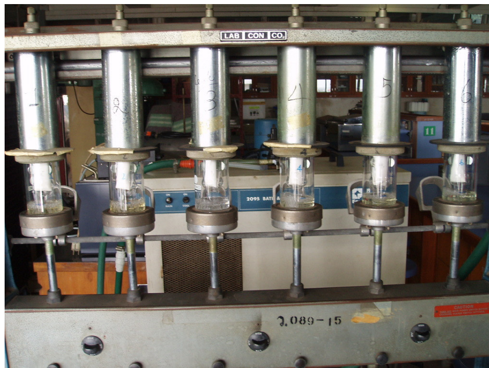
รูปที่ 3 การหาปริมาณ crude fat โดยใช้ Goldfish fat extraction apparatus
