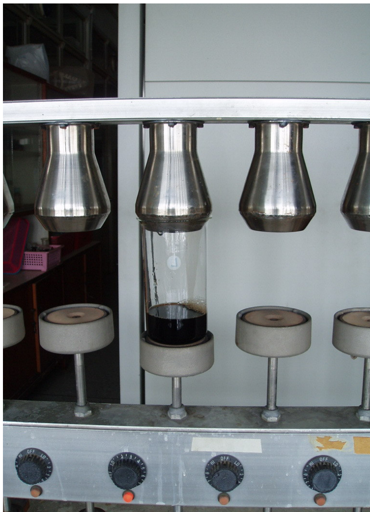
รูปที่ 6 การหาปริมาณ Crude fiber โดยใช้ Crude Fiber Digestion Apparatus
