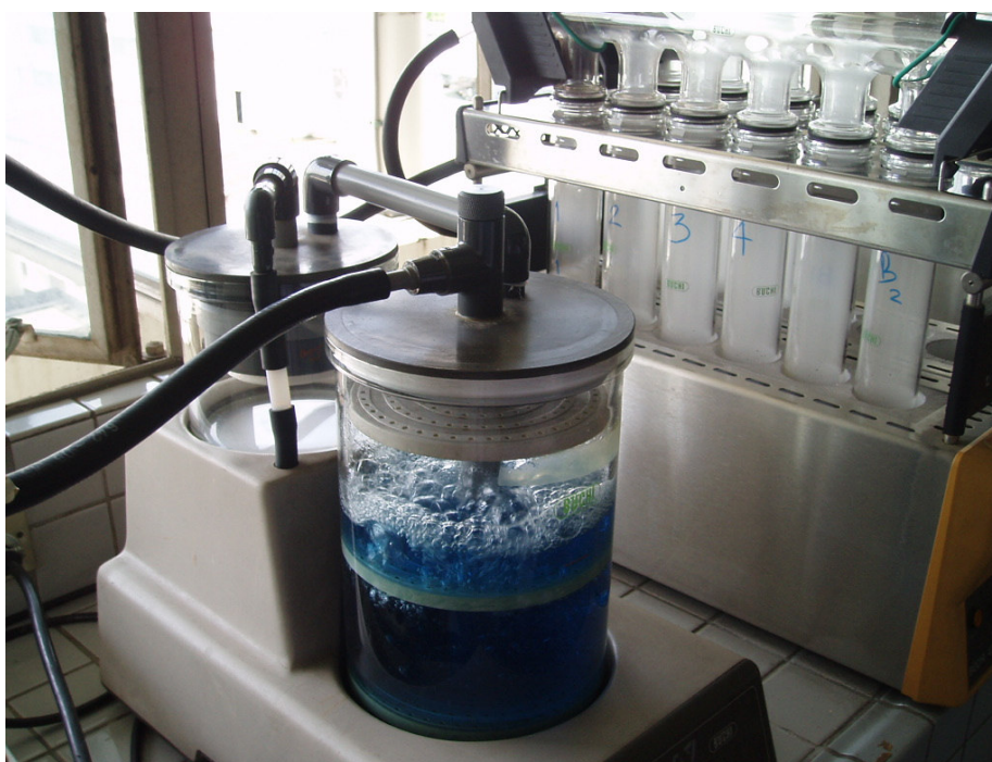
รูปที่ 4 การหาปริมาณ Crude protein ชั้น Digestion โดยใช้ Digestion Unit
