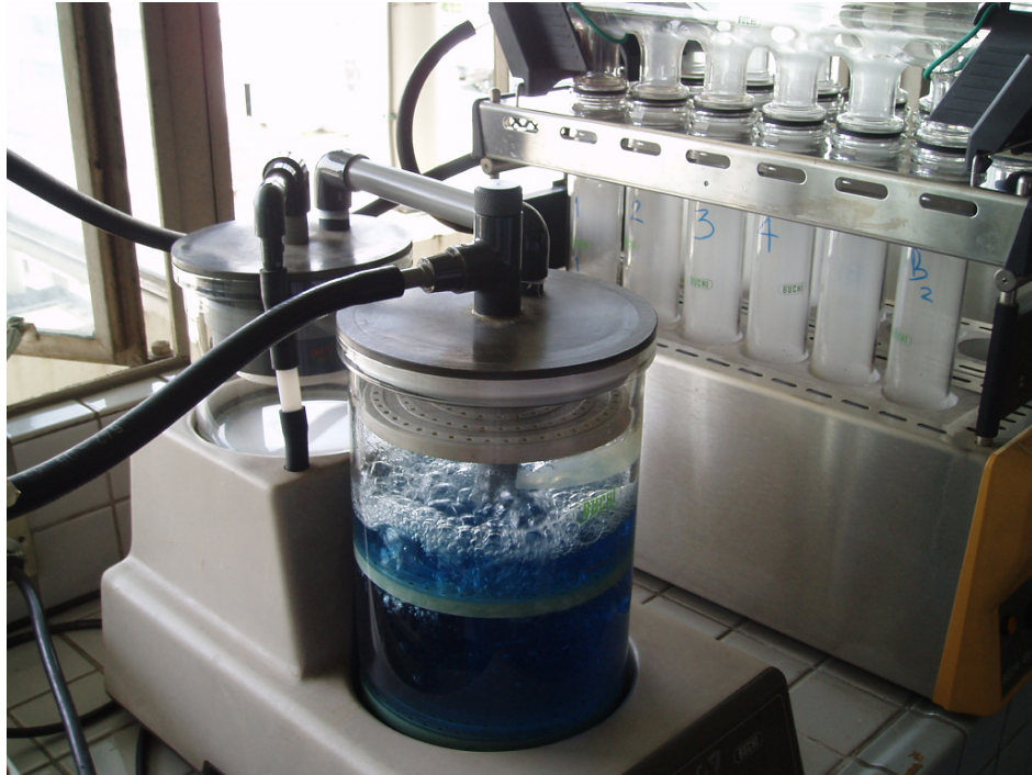
รูปที่ 8 Buchi digestion unit และ scrubber
