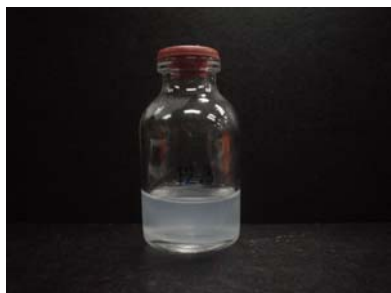
suspension ที่ได้จากโซลิดดิสเพอร์ชัน ที่ประกอบด้วย Ibuprofen, L-HPC และ Gelucire 44/14 ในอัตราส่วน 1:3:3
