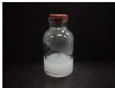
suspension ที่ได้จากโซลิดดิสเพอร์ชัน ที่ประกอบด้วย Ibuprofen, L-HPC และ Gelucire 44/14 ในอัตราส่วน 1:5:5
