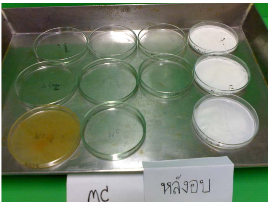
รูปที่ 2 แผ่นฟิล์ม Methylcellulose 2 %w/v ที่มีสารช่วยในตำรับ 1 ชนิดได้แก่ สารในกลุ่ม plasticizer, titanium dioxide กลิ่นและสี หลังอบ
