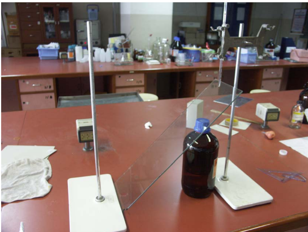
รูปที่ 3 การติดตั้งอุปกรณ์การวัดเวลาในการแห้งและระยะทางในการไหลบนพื้นเอียง
