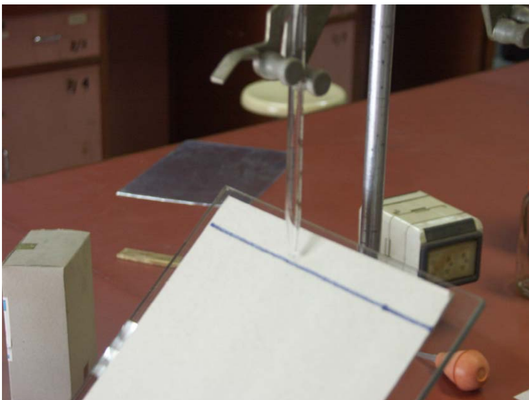
รูปที่ 4 การติดตั้งอุปกรณ์การวัดเวลาในการแห้งและระยะทางในการไหลบนพื้นเอียง
