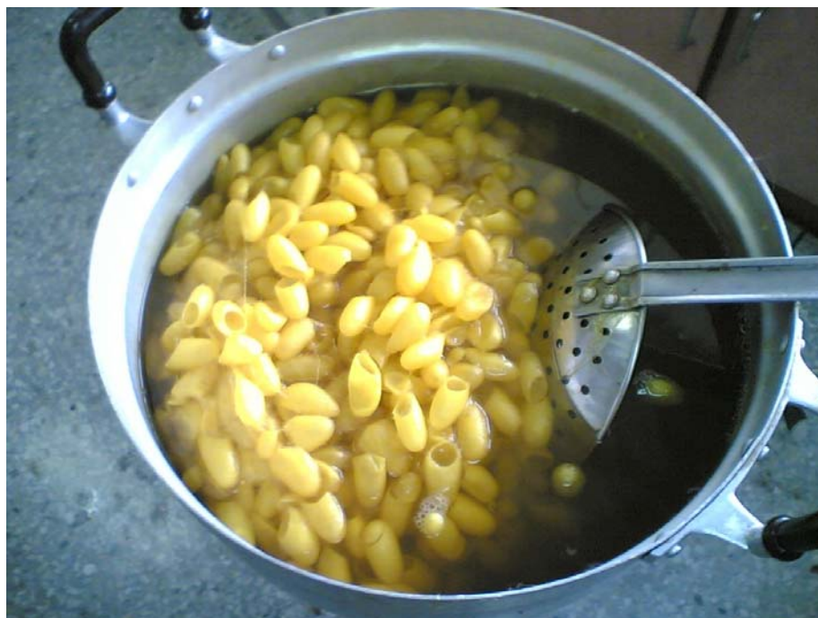
รูปที่ 3 การสกัดแยก sericin จากรังไหม
