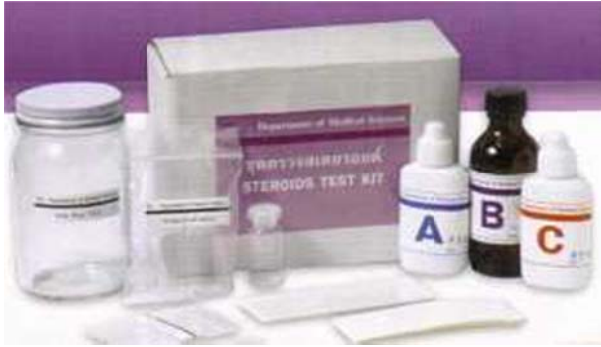
รูปที่ 1 ชุดตรวจสอบสเตียรอยด์ หลักการแยกสารด้วย Thin Layer Chromatography
