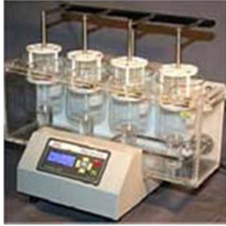
รูปที่ 5 เครื่องทดสอบการแตกตัวของยาเม็ด
