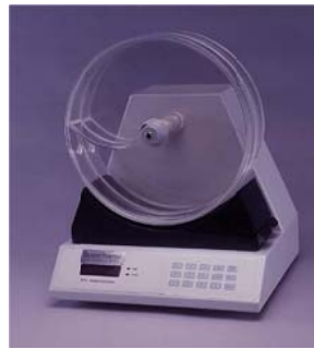
รูปที่ 4 แสดงเครื่องทดสอบความกร่อนยาเม็ด
