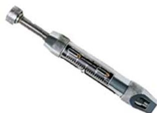
รูปที่ 3 แสดงเครื่องวัดความแข็งยาเม็ด
