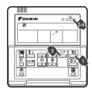
กดปุ่มเลือกรูปแบบการทำงานและเลือก " 🚹 " (ระบบระบายความชื้น)
