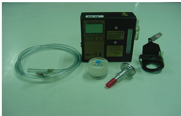
ภาพที่ 2.7 ชุดเครื่องมือเก็บตัวอย่างอากาศชนิดอนุภาคขนาดเล็ก
