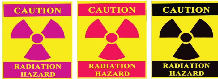
ภาพที่ 2.7 สัญลักษณ์รังสีที่ใช้ในห้องปฏิบัติการทางรังสี
